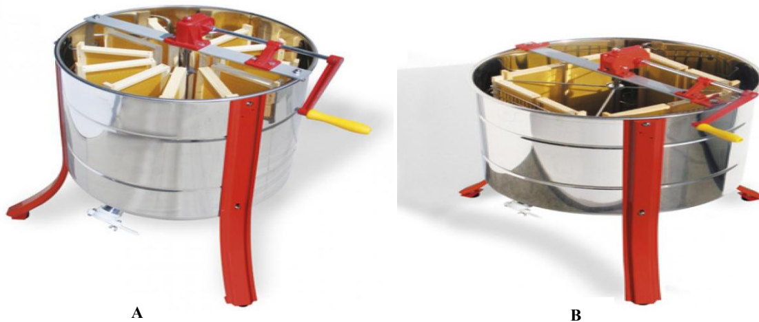
Figure 26 : Cadres dans un extracteur; A/ Extracteur radiaire; B/ Extracteur tangential.
